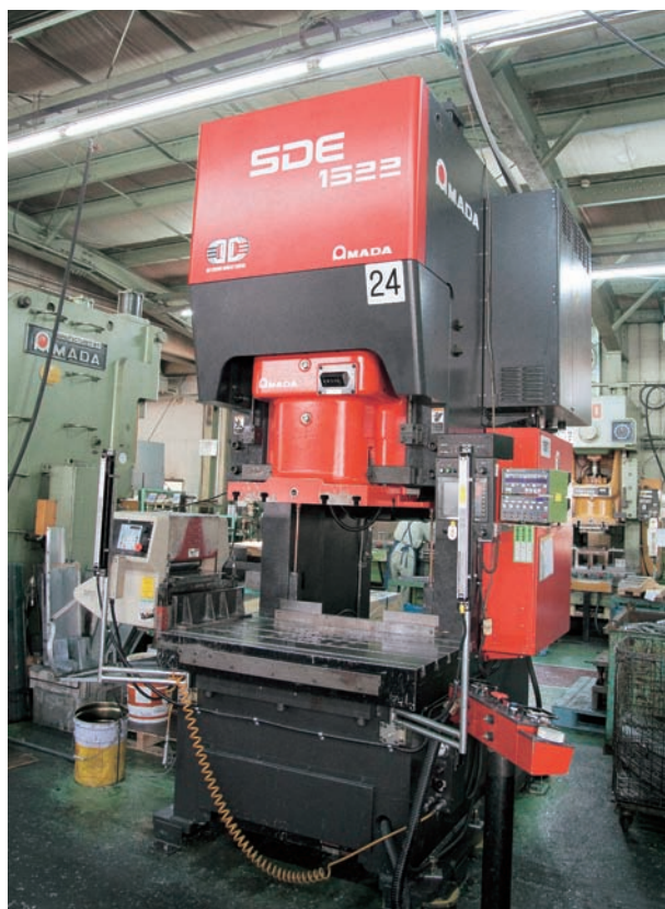
サーボプレス SDE-1522。サーボプレスならではの機能(下死点での一時停止や加工速度・モーションの細かな設定)が「リークゼロロッキング工法」の開発に大きく貢献した
