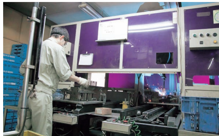
6軸ロボット溶接機を2台設備。移動式のマルチステーションで、加工中と段取りを同時に行うことで工数を削減
