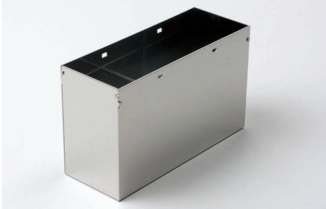
「リークゼロコーキング工法」で加工したステンレスのケース(板厚 1.0mm)。打ち抜き・曲げのプレス2工程でケース成形と水漏れ防止処理を行える。目止め処理が不要で、大幅なコストダウンと納期短縮、品質向上を実現した。現在、特許出願中。
