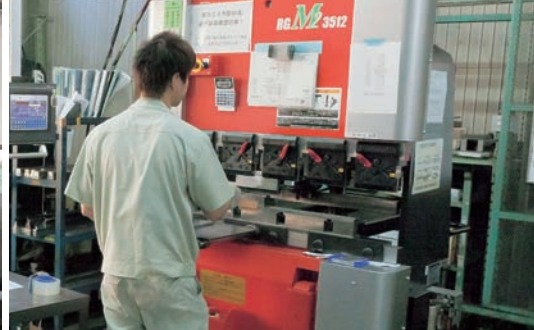
曲げ工程。試作や「電機部」の製品は板金加工に対応
